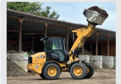
La version "High-Lift" de la 908 vous permet d'atteindre une hauteur de déversement supérieure à celle d'une 920 équipée d'un brancard standard.
